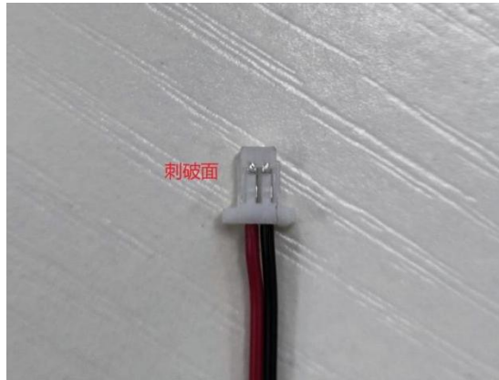
(刺破面 例图:左红右黑线序)
